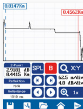
Anzeige der OTDR-Kurve zur weiteren Auswertung
