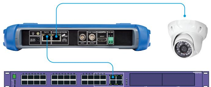
Stromversorgung der Kamera über den RJ45-Anschluss durch eine PoE+-Schleife vom Netzwerk durch den Tester hindurch.
