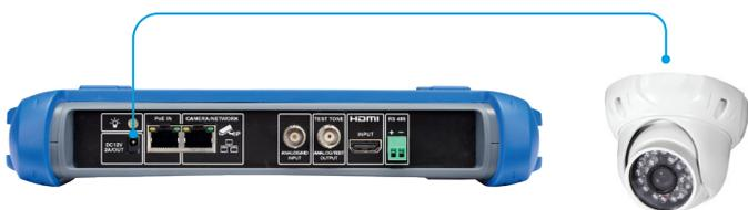
Stromversorgung der Kamera über den Klinkenstecker (2,5 auf 3,5 mm, 12 VDC/2 A) vom Tester.
